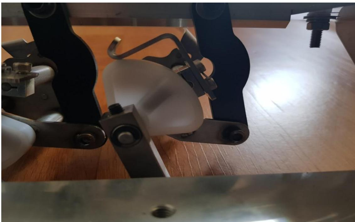
6. 抓住鸡蛋的指头和后板的孔必须调准贯通。
